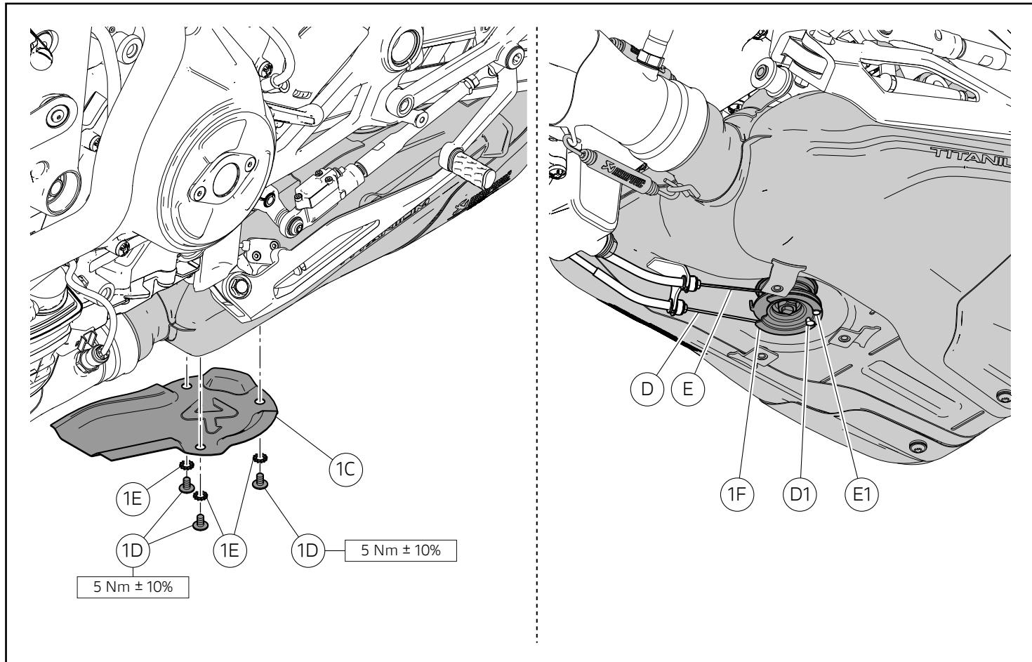
Quitar los 3 tornillos (1D) con las 3 arandelas (1E). Quitar el cover (1C) para permitir las operaciones de posicionamiento de los cables del motor válvula de escape. Introducir los dos trinquetes (D1) y (E1) de los cables (D) y (E) en los respectivos alojamientos de la polea (1F).
