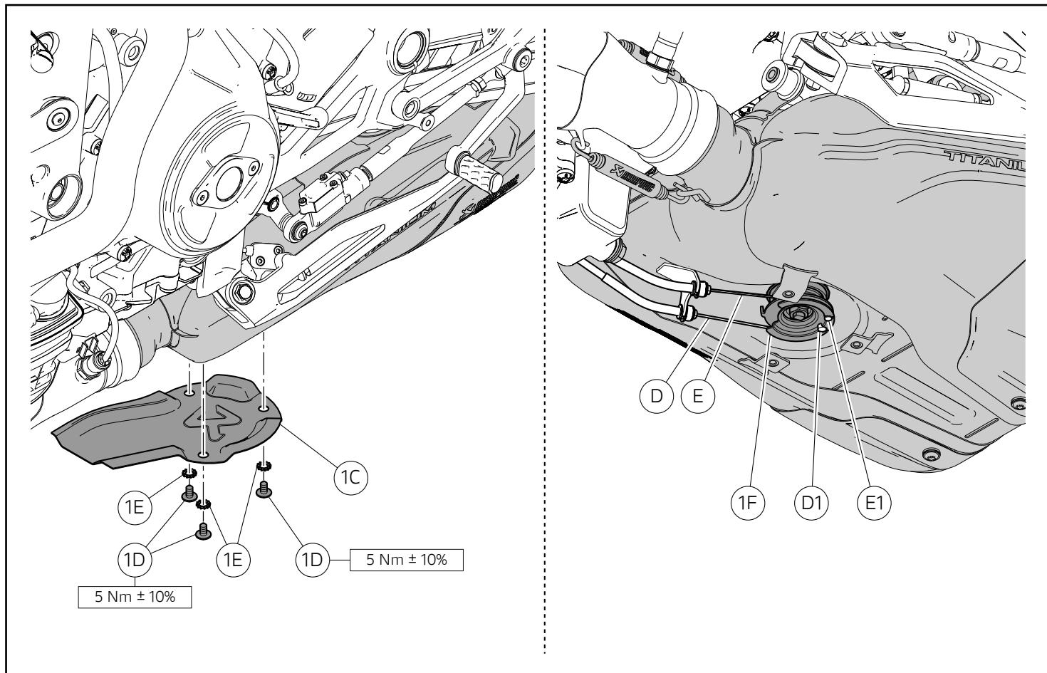
Remova os 3 parafusos (1D) com as 3 anilhas (1E). Remova a cobertura (1C) para permitir a operação de reposicionamento dos cabos do motor da válvula de escape. Insira os dois pinos (D1) e (E1) dos cabos (D) e (E) nas respetivas sedes da polia (1F).
