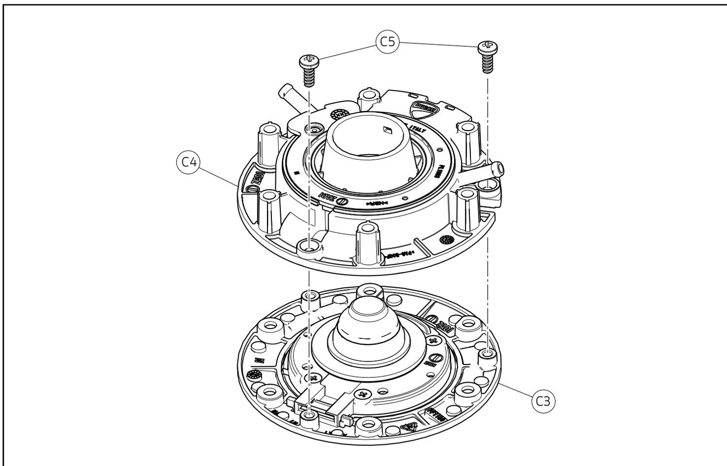
Svitare e rimuovere le n.2 viti (C5). Estrarre la parte superiore (C3), recuperando la parte inferiore (C4), che dovrà essere riutilizzata per il montaggio del kit.
