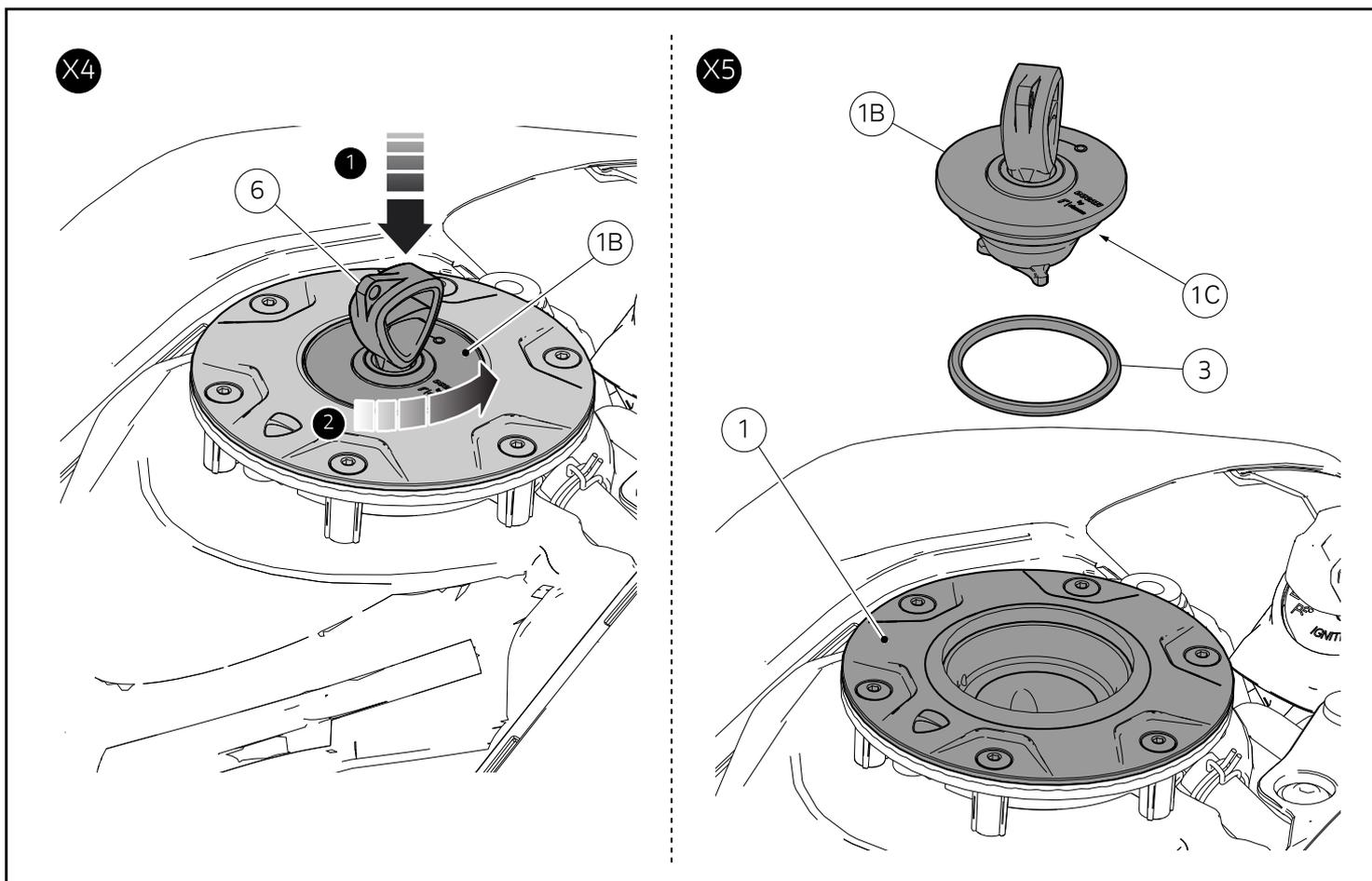
Posizionare la chiave (6) sul tappo (1B). Per rimuovere il tappo (1B), premere con forza sul tappo stesso e ruotarlo in senso antiorario, sino al suo completo sblocco come mostrato in figura (X4).
