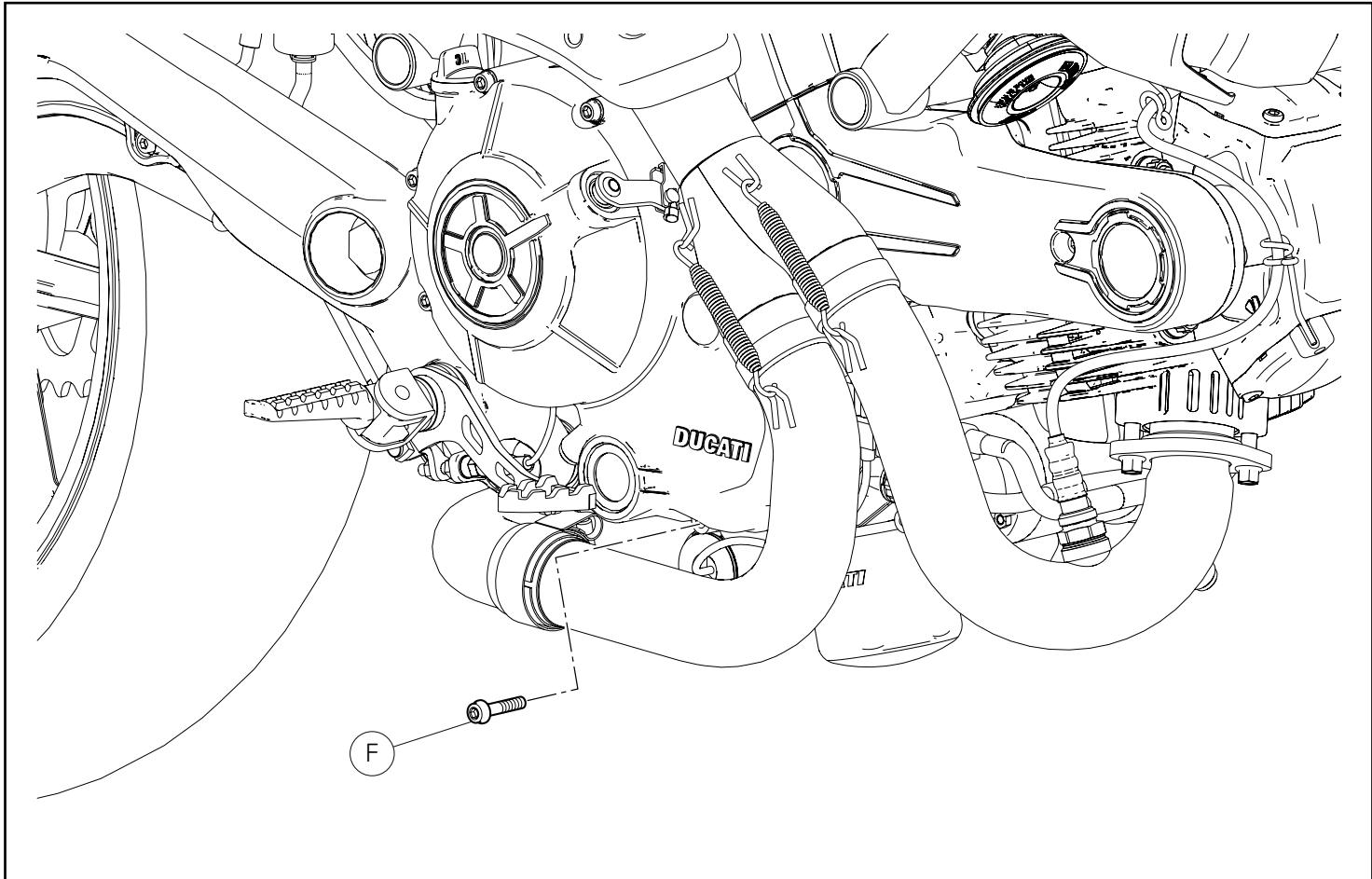
Operando del lado derecho de la motocicleta, desatornillar el tornillo (F) de fijación de la tapa embrague.
