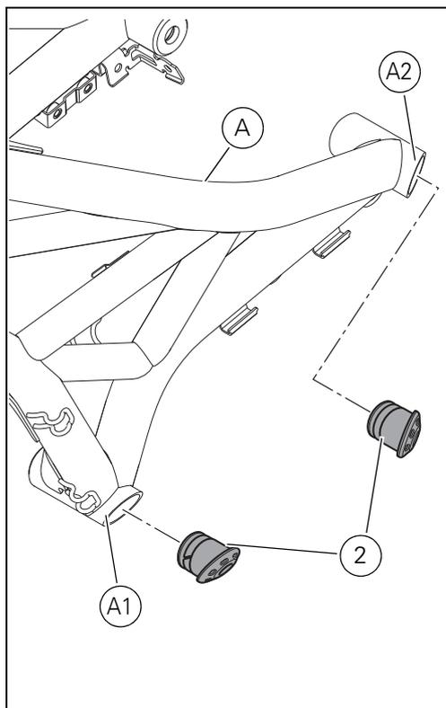
Introducir los 3 conjuntos tapón bastidor (2) en los casquillos (A1), (A2) y (A3) del bastidor (A) empujando el tapón (2B) a tope. Ajustar los 3 tornillos (2A) al par de apriete de  $10 \pm 10\%$  Nm.
