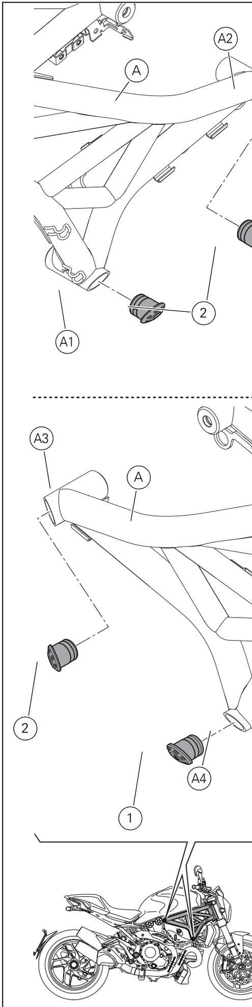
Introduire les 3 ensembles du bouchon du cadre (2) dans les bagues (A1), (A2) et (A3) du cadre (A) en poussant le bouchon (2B) jusqu'en butée.
