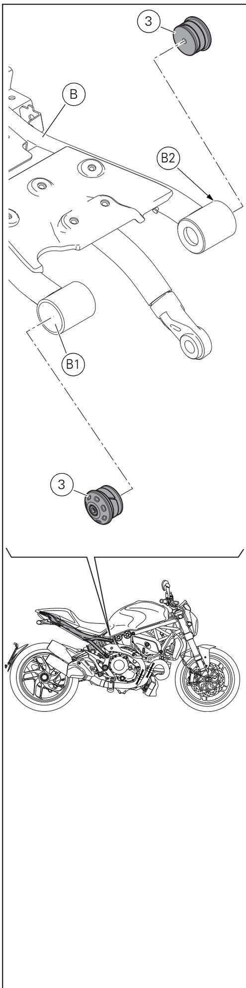
Introdurre i n.2 assiemti tappo telaio (3) nelle boccole (B1) e (B2) del telaio posteriore (B) spingendo il tappo (3B) fino a battuta. Serrare le n.2 viti (3A) alla coppia di  $10 \pm 10\%$  Nm.
