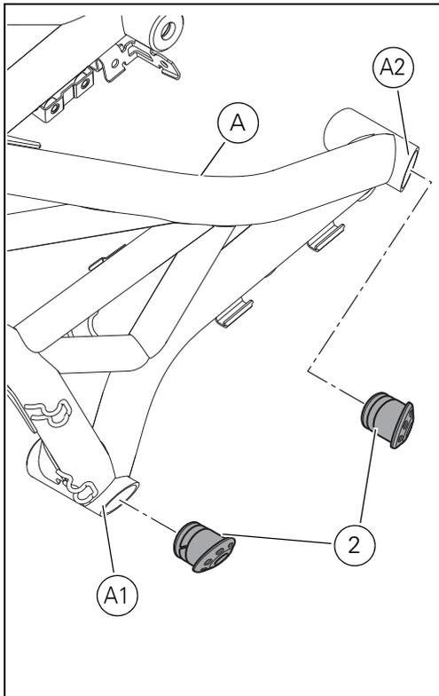
Introdurre i n.3 assiemii tappo telaio (2) nelle boccole (A1), (A2) e (A3) del telaio (A) spingendo il tappo (2B) fino a battuta.
