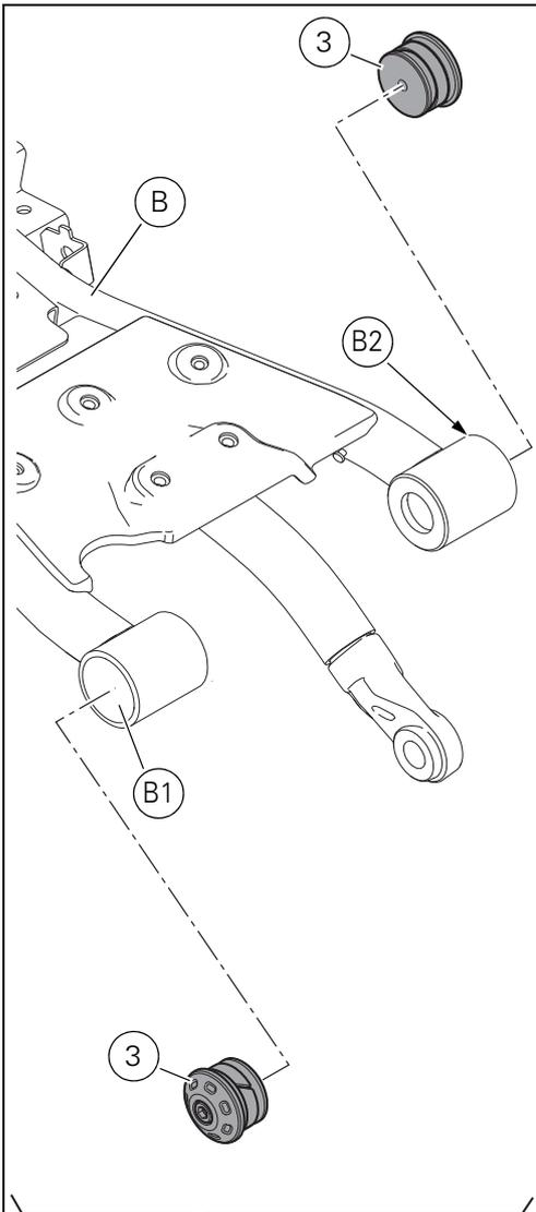
Introduire les 2 ensembles du bouchon du cadre (3) dans les bagues (B1) et (B2) du sous-cadre arrière (B) en poussant le bouchon (3B) jusqu'en butée. Serrer les 2 vis (3A) au couple de serrage  $10 \pm 10 \%$  Nm.
