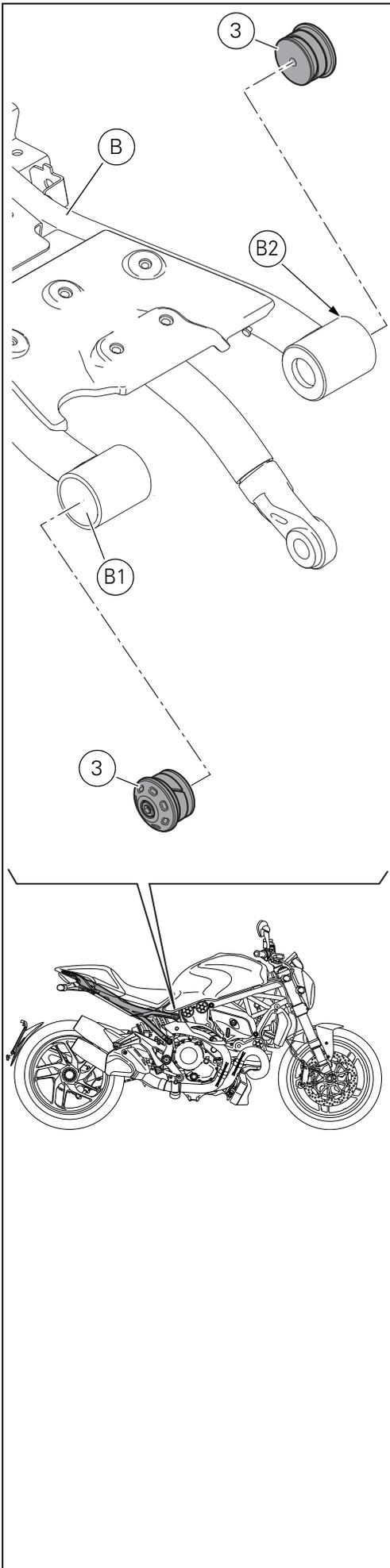
Introducir los 2 conjuntos tapón bastidor (3) en los casquillos (B1) y (B2) del subchasis trasero (B) empujando el tapón (3B) a tope. Ajustar los 2 tornillos (3A) al par de apriete de  $10 \pm 10\%$  Nm.
