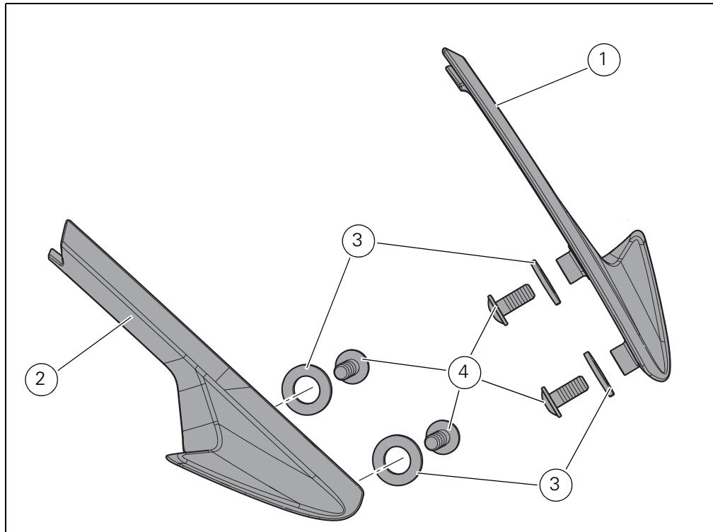
Os particulares com referência evidenciados por um círculo representam o acessório a instalar e os eventuais componentes de montagem.
