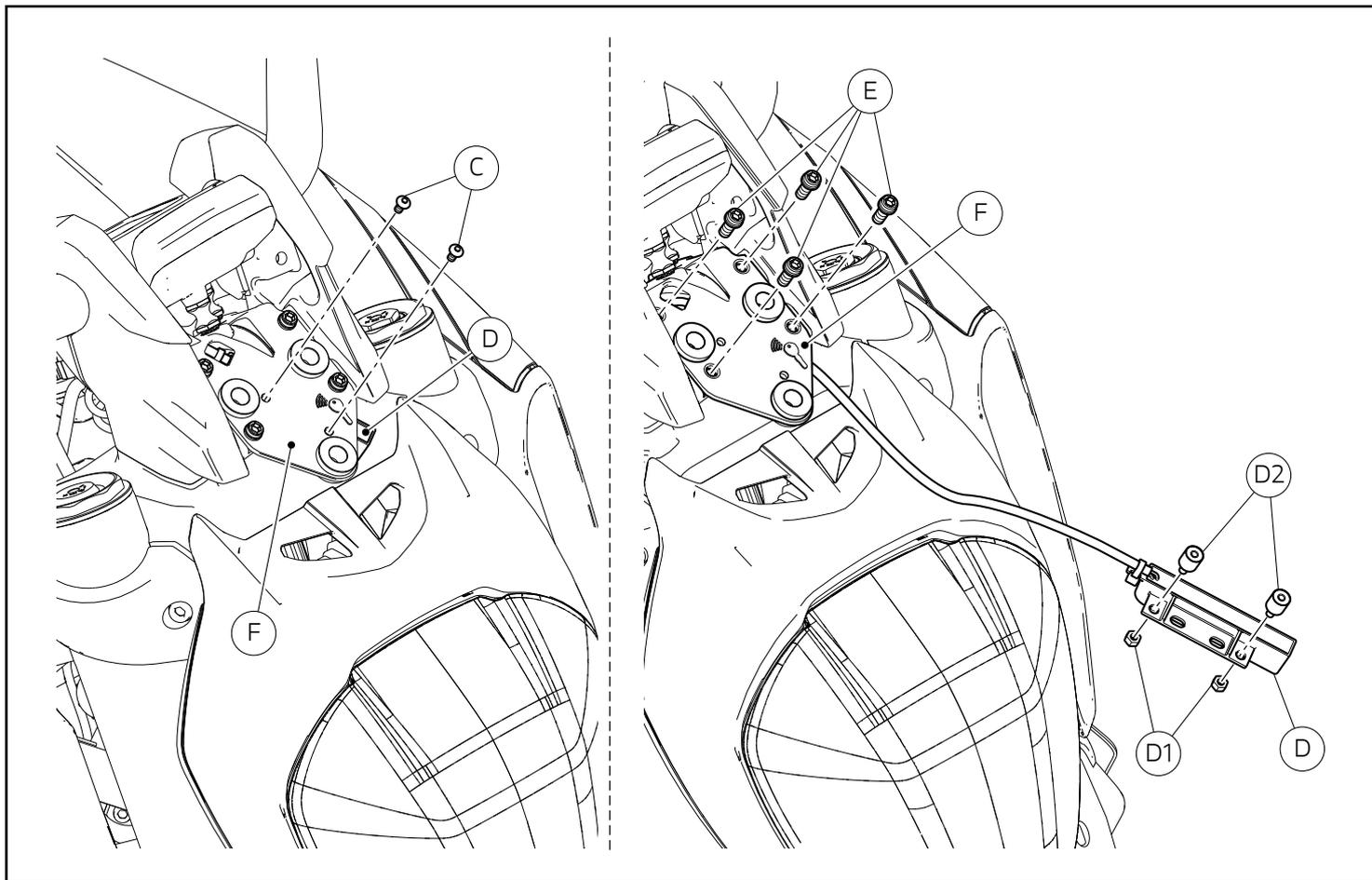
Desatornillar y quitar los 2 tornillos (C) que fijan la antena (D) al soporte cover delantero (F).
