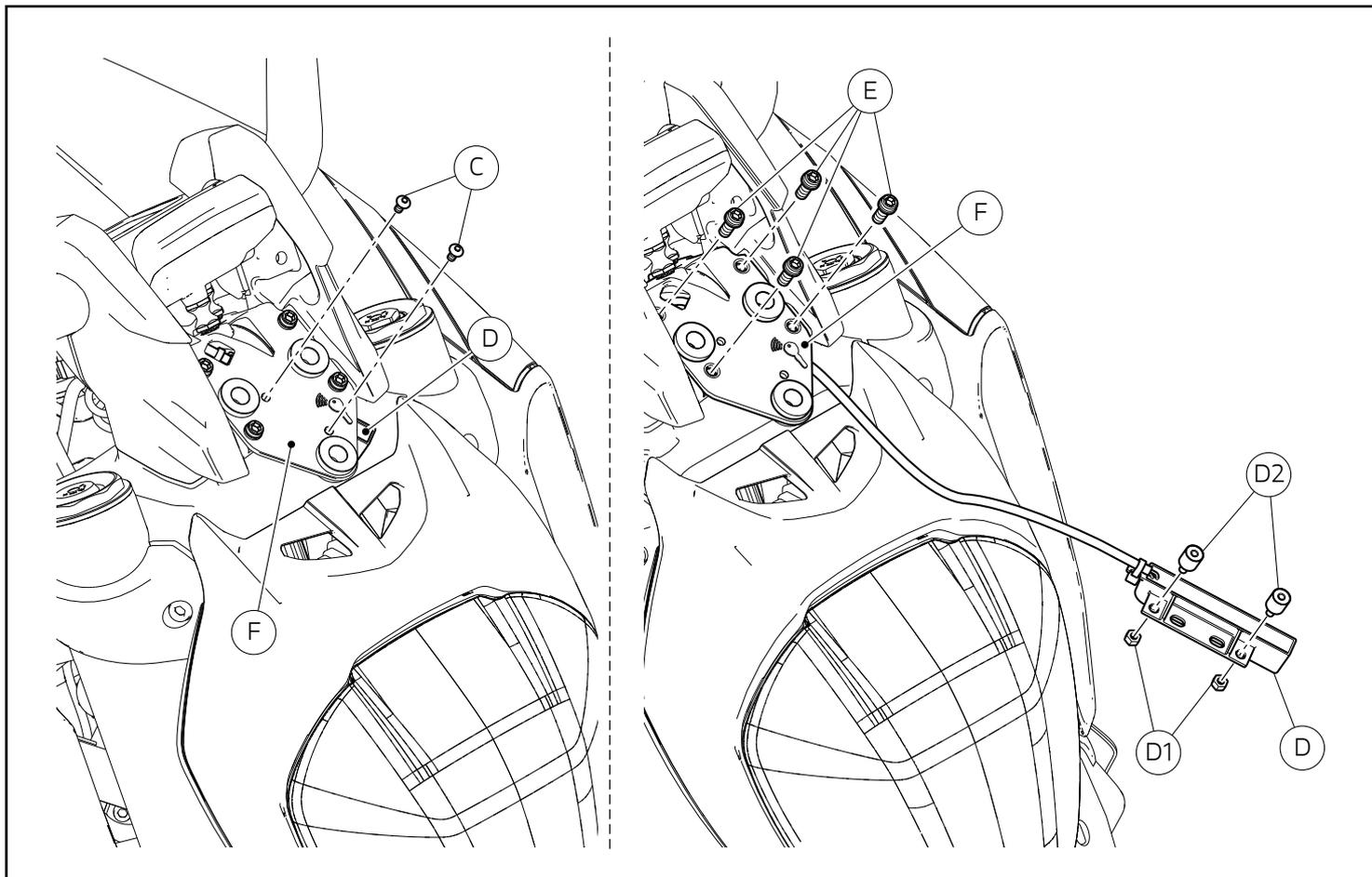
Svitare e rimuovere le n.2 viti (C), che fissano l'antenna (D) al supporto cover frontale (F).
