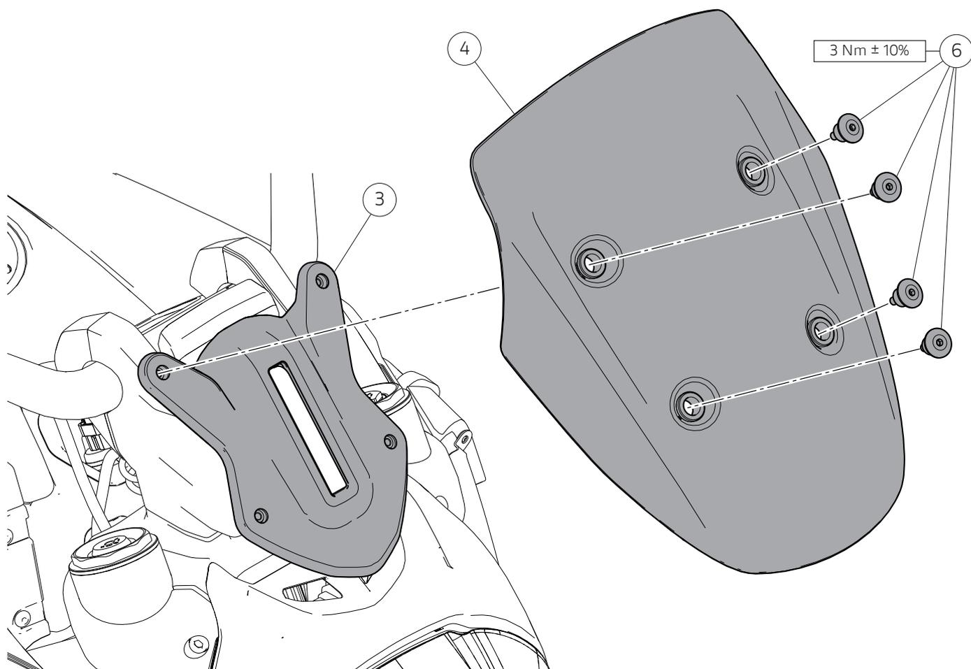
Pré-monter les 4 plots caoutchouc (5) sur la bulle (4).
