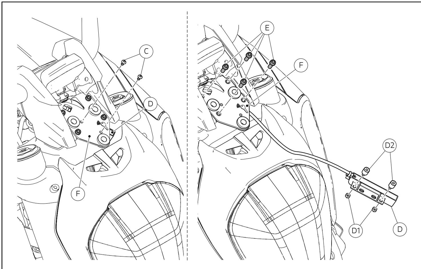
Desatarraxe e remova os 2 parafusos (C), que fixam a antena (D) no suporte da cobertura frontal (F).
