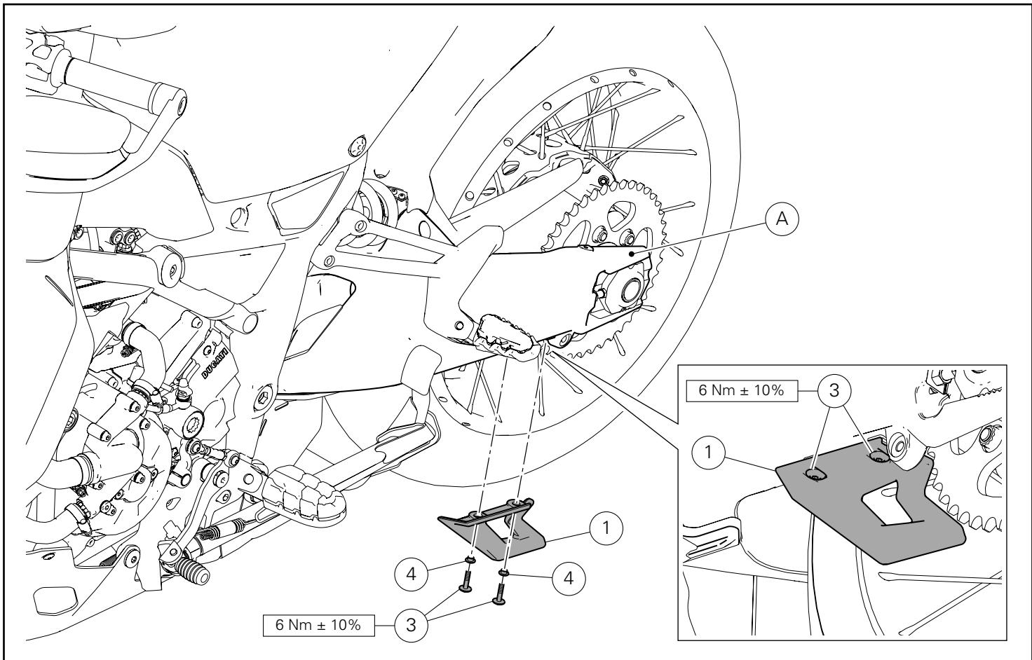
Montagem da proteção para corrente inferior no braço oscilante com furos M5
