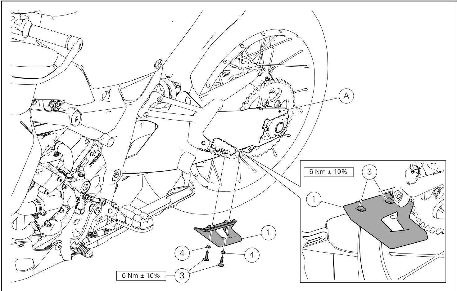
Montaje protección cadena inferior en basculante con orificios M5
