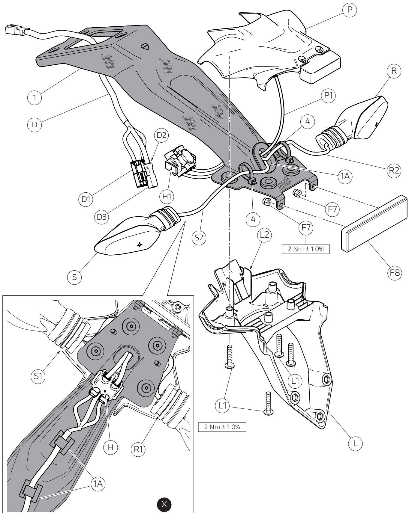
Premontar el catadióptrico original (F8) en el sostén porta-matrícula (1) introduciendo los pernos roscados en los orificios. Introducir las 2 tuercas originales (F7). Ajustar las 2 tuercas (F7) al par de apriete indicado.
