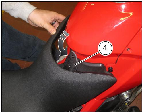
Lorsque le sac ou la sacoche ne sont pas utilisés, il est possible de tourner la bride arrière (4) en bas afin que la selle pilote puisse la protéger.
