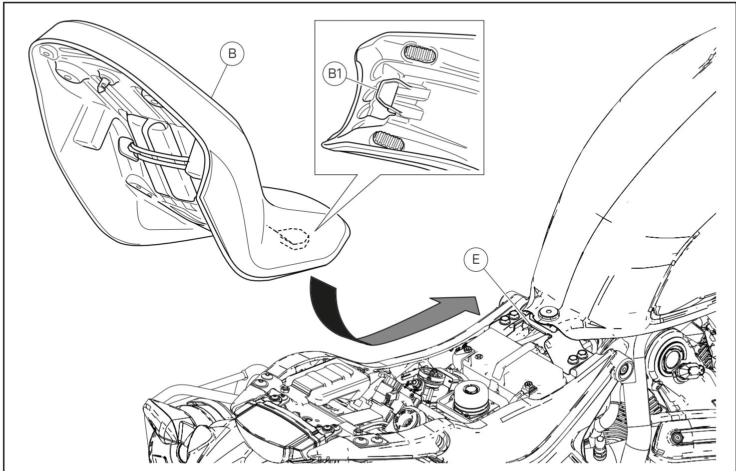
Assicurarsi che tutti gli elementi siano correttamente disposti e fissati nel vano sotto la sella. Inserire l'estremità anteriore (B1) del fondo sella sotto alle sede (E) del supporto telaio. Spingere sull'estremità posteriore della sella (B) fino ad udire lo scatto del chiavistello della serratura. Assicurarsi che la sella sia saldamente fissata al telaio e rimuovere la chiave dalla serratura.
