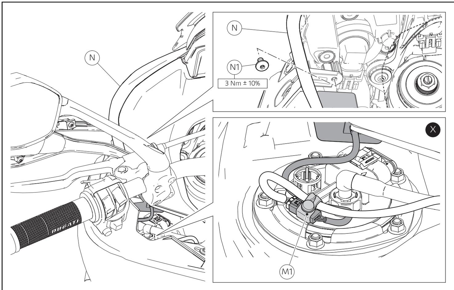
Posicionar nuevamente el tablero izquierdo (N) e introducir el tornillo original (N1). Ajustar el tornillo (N1) al par de apriete indicado.
