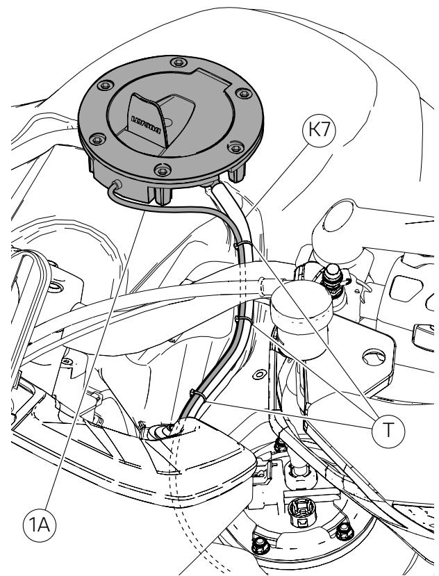
Insérer le collier serre-flex (K5) sur la durite reniflard (K6). Relier la durite reniflard (K6) et la durite d'égouttage (K7) au bouchon réservoir (1), comme la figure (Z1) le montre. Disposer le câble du bouchon électronique (1A), le long de la durite d'égouttage (K7) et le fixer, à l'aide de 3 petits colliers serre-flex en plastique (T) comme la figure (Z2) le montre.
