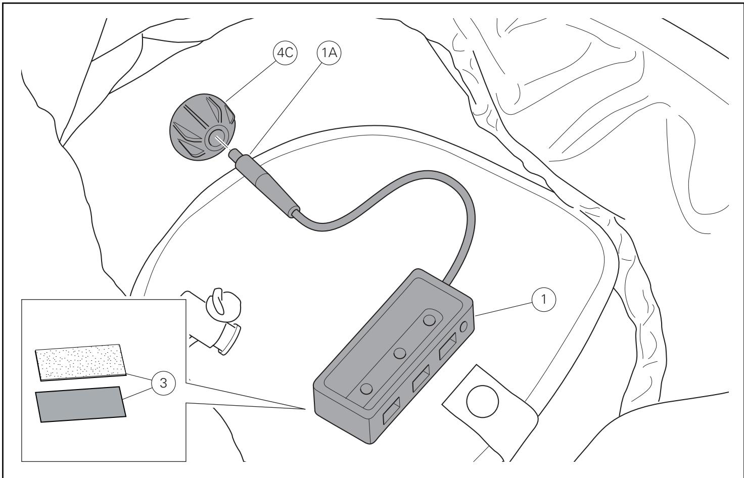
Introducir el conector (1A) del hub USB (1) en el acople (4C).
