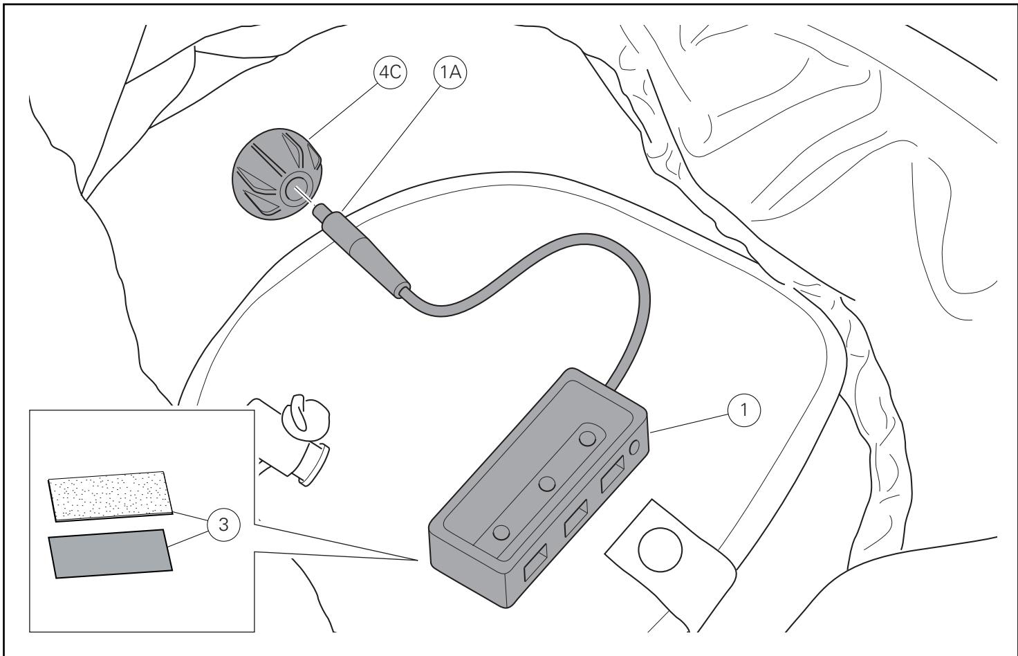
Inserire nell'innesto (4C) il connettore (1A) dell'hub USB (1).
