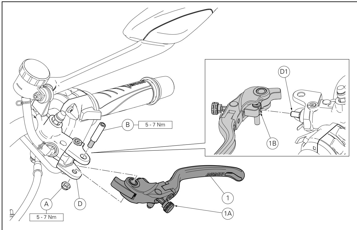
En agissant du côté gauche du motocycle, poser le levier d'embrayage (1) sur le maître-cylindre d'embrayage (D), en introduisant le pivot (D1) dans le crampon (1B). Présenter le pivot d'origine (B) sur le maître-cylindre d'embrayage (D). Serrer le pivot (B) au couple prescrit. Du côté opposé, visser l'écrou d'origine (A) sur le filet du pivot (B). Serrer l'écrou (A) au couple prescrit.
