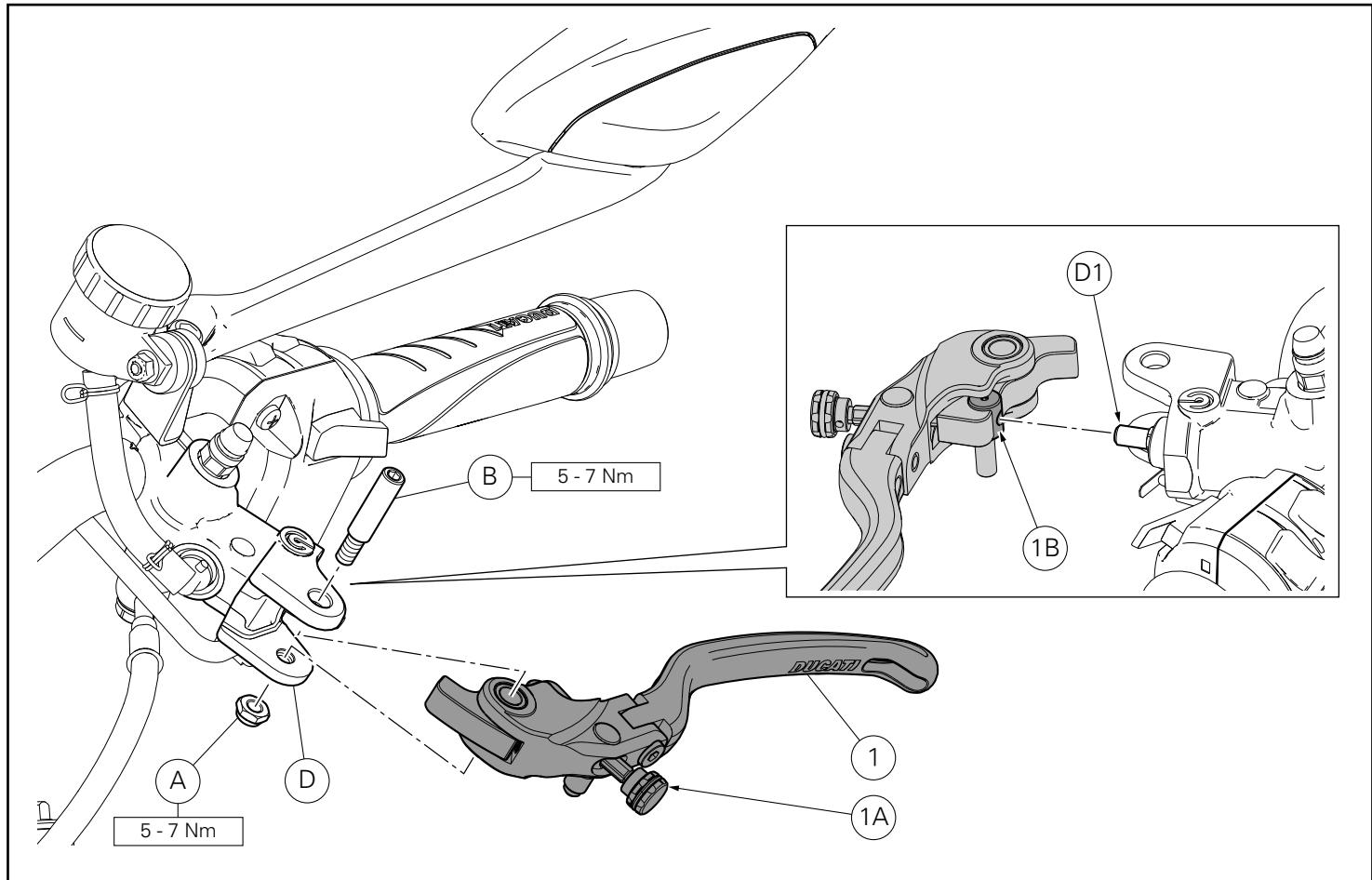
Operando en el lado izquierdo de la motocicleta, montar la leva embrague (1) en la bomba embrague (D), introduciendo el perno (D1) en el trinquete (1B). Introducir el perno original (B) en la bomba embrague (D). Ajustar el perno (B) al par de apriete indicado. Del lado opuesto, atornillar la tuerca original (A) en la rosca del perno (B). Ajustar la tuerca (A) al par de apriete indicado.
