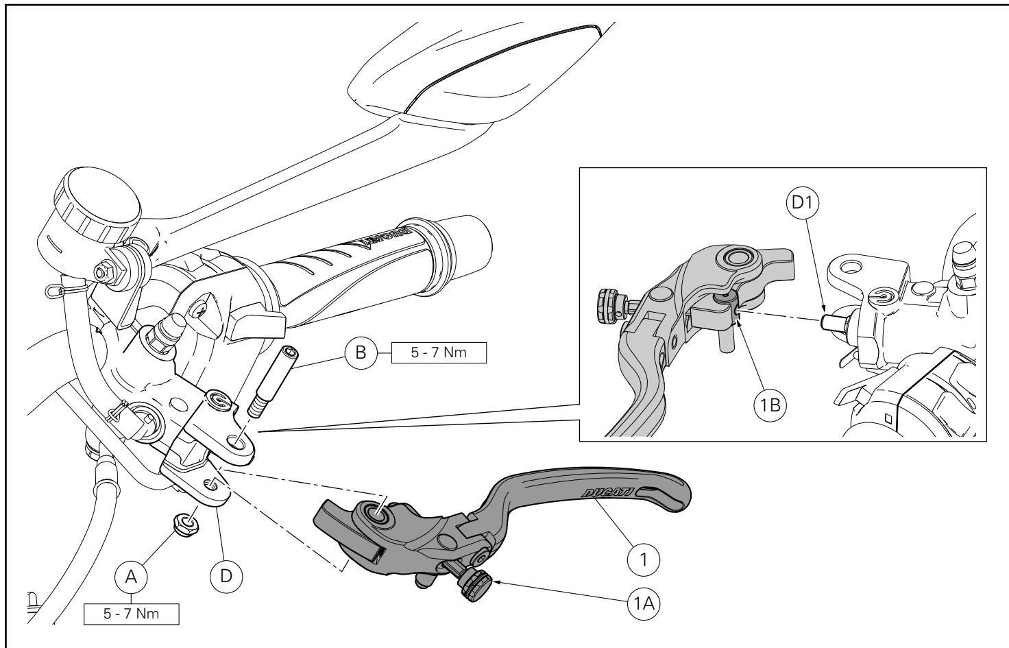
Operando sul lato sinistro del motoveicolo, montare la leva frizione (1) sulla pompa frizione (D), introducendo il perno (D1) nel nottolino (1B). Impuntare il perno originale (B) sulla pompa frizione (D). Serrare il perno (B) alla coppia indicata. Dal lato opposto, avvitare il dado originale (A) sul filetto del perno (B). Serrare il dado (A) alla coppia indicata.
