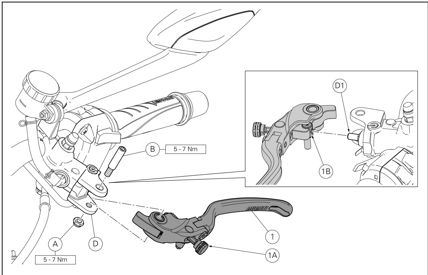
Atuando no lado esquerdo da moto, monte a alavancada embraiagem (1) na bomba da embraiagem (D), introduzindo o perno (D1) no pino (1B). Encoste o perno original (B) na bomba da embraiagem (D). Aperte o perno (B) ao binário indicado. Pelo lado oposto, atarraxe a porca original (A) na rosca do perno (B). Aperte a porca (A) ao binário indicado.
